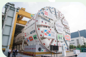
屯門至赤鱗角連接路—北面連接路海底隧道段工程所使用的隧道鑽挖機
