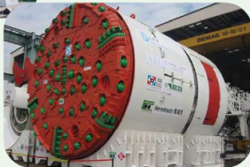
港島西雨水排放隧道工程所使用的隧道鑽挖機
