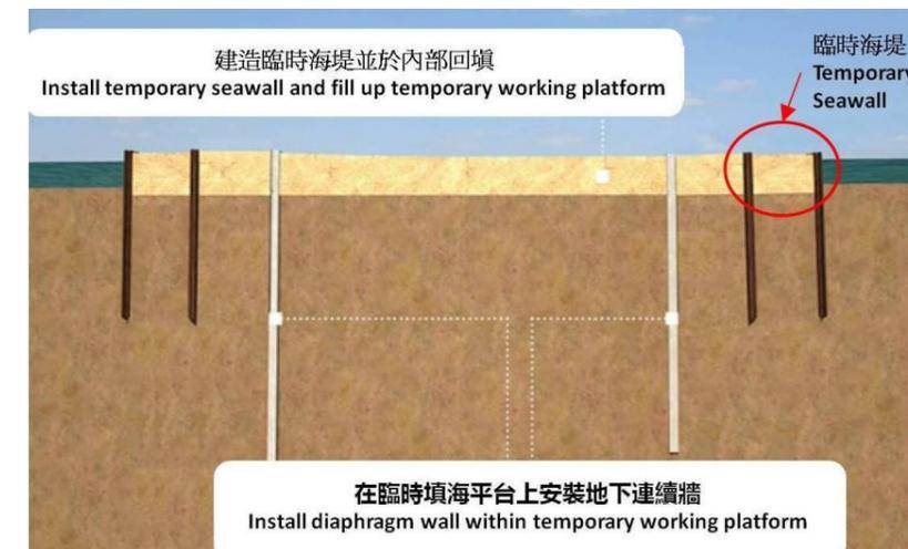
圖 3-15 (a) - 明挖回填法配以臨時填海 - 第一步
