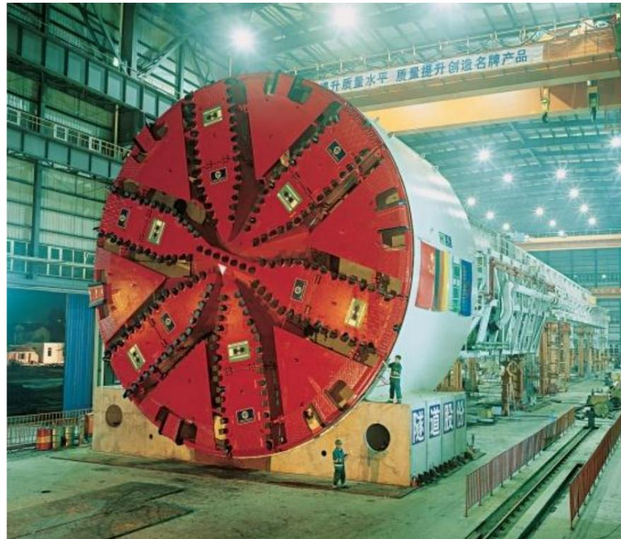
圖 3-8 - 隧道鑽挖機
