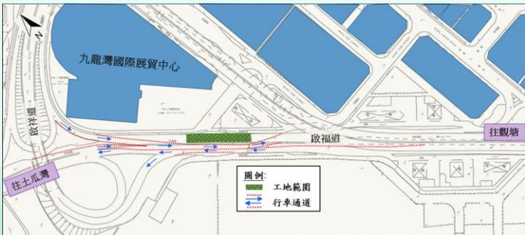
第二階段 - 封閉啟福道東行車道，並在西行車道實施雙程雙線行車的臨時交通安排
