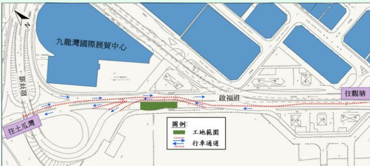
第一階段 - 封閉啟福道西行車道，並在東行車道實施雙程雙線行車的臨時交通安排
