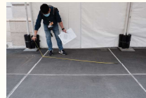
測量人員分別用目視方式進行樓宇狀況勘测、量度地面裂縫及用儀器評估建築物的結構狀況
