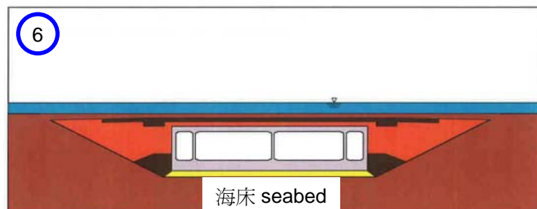
沉管式隧道建築程序 (截面圖)
